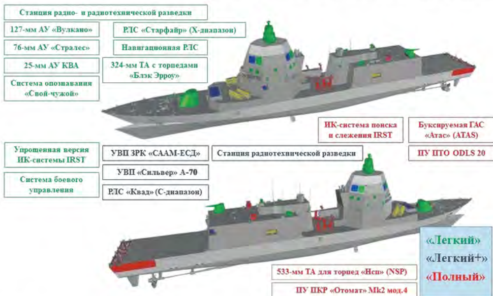
Варианты оснащения фрегатов типа «Паоло Таон ди Ревел» в модификациях «Легкий», «Легкий+» и «Полный»
